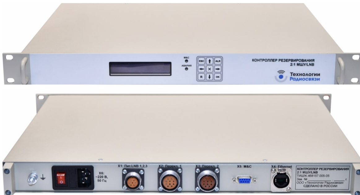
Рисунок 5 – Внешний вид контроллера резервирования 2:1 МШУ/LNB
